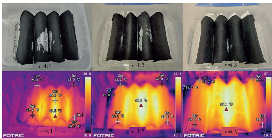
(c) 24 h 下两侧非对称供水层数比例不同收集装置的耐盐效果与温度分布
