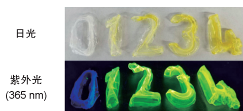
图7 不同体积分数Y-CDs(0%、1%、2%、3%和4%)的PVA膜在日光和紫外光(365 nm)下的照片
