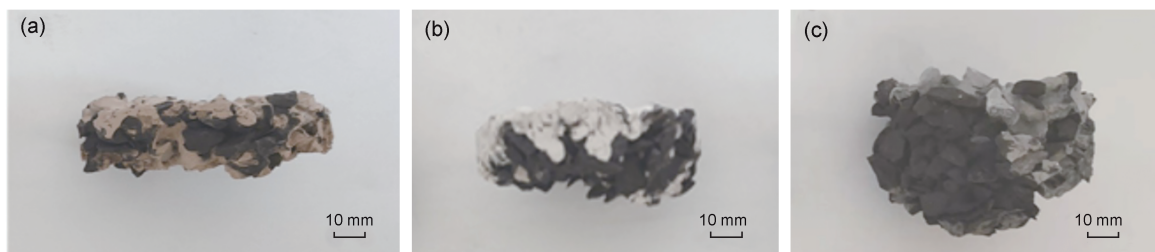
图4 各组浆液与粒径8 mm~18 mm矸石颗粒形成的固结体
