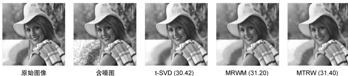
图7 三种多帧图像去噪方法的局部细节放大结果比较
