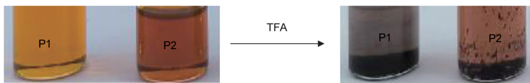
图5 P1@Arc-SWCNTs和P2@Arc-SWCNTs分散液加入TFA并超声后释放Arc-s-SWCNTs
