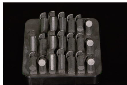
图5 打印完成的部分卡环样本 Fig.5 3D printed partial clasp samples
