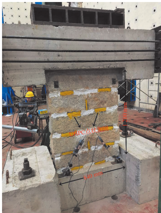
图 1 点状嵌缝加固试件
