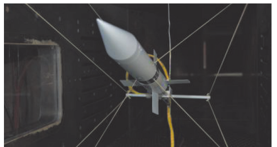
图 18 试验段绳牵引支撑旋转弹箭模型
