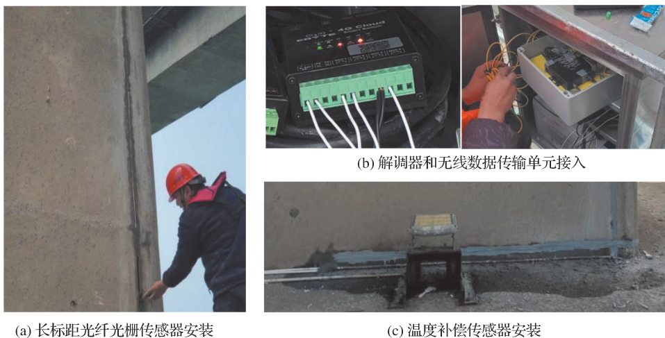
图 6 长标距光纤光栅传感的腐蚀监测
