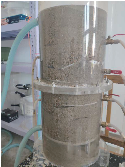
图 9 试样内设置多层土工布时发生的渗透破坏
