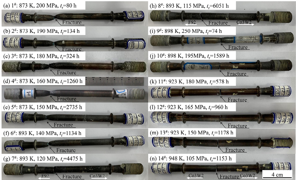
图 1 耐热钢焊接件高温拉伸蠕变断裂试样
