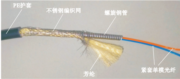
图 4 螺旋铠装光缆
