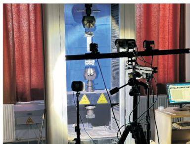
(a) 膜材拉伸试验装置
