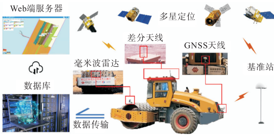
图 2 堆石坝施工实时监控系系统
