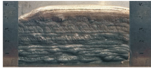
图 4 304L/TC4 梯度材料单壁墙试件
