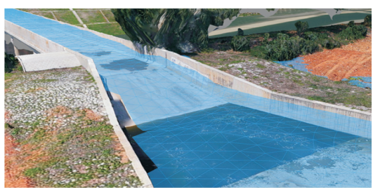
(f) 200 年一遇洪水工况下 19 h 时渡槽出口渐变段处可视化效果
