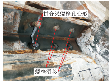
(c) 试验破坏形态 2
