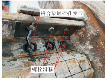
(c) 试验破坏形态 2
