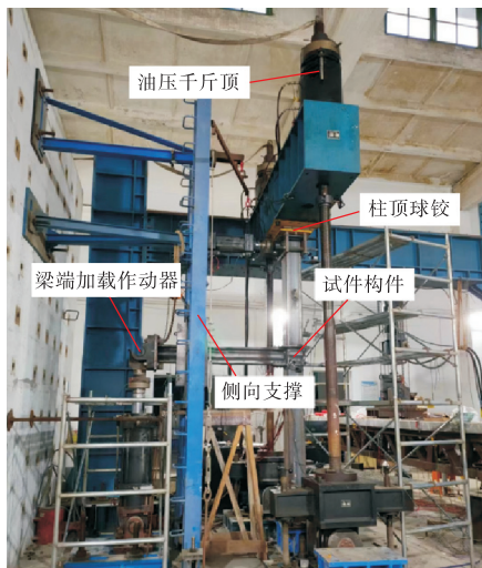
(b) 加载装置照片
