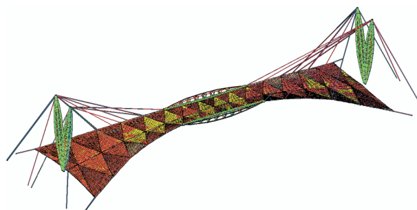
图 6 结构的高保真有限元模型
