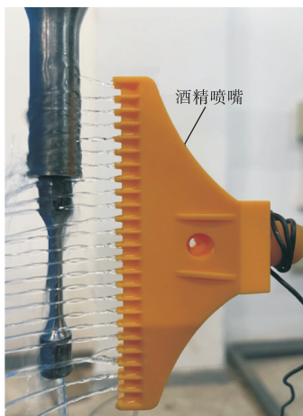
图 4 超声疲劳试验酒精冲洗示意
