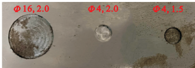
图 12 内壁缺陷放大
