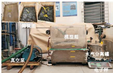
图6 模型试验装置实物图 Fig.6 Photo of model test equipment
