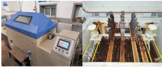
图 5 中性盐雾试验试验机 Fig.5 Neutral salt spray test machine
