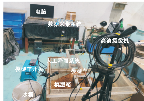
图1 可视化弱膨胀软土路基边坡溜塌模型试验装置系统
