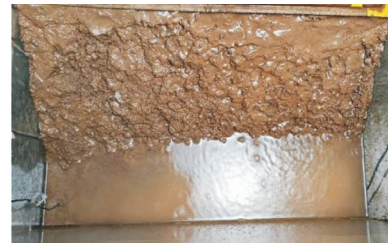
图 9 降雨结束后边坡溜塌
