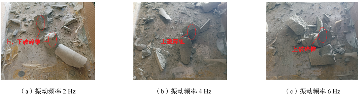
图 9 振动冲击复合加载下青砂岩的破裂特征(改变振动频率)
