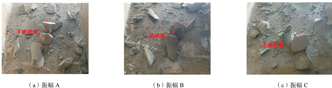
图 10 振动冲击复合加载下青砂岩的破裂特征(改变振幅)
