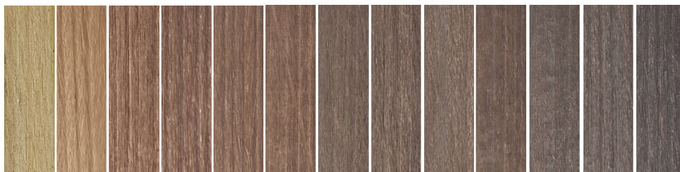
对照组 140 °C 140 °C 140 °C 140 °C 160 °C 160 °C 160 °C 160 °C 180 °C 180 °C 180 °C 180 °C 0 5% 10% 20% 0 5% 10% 20% 0 5% 10% 20%
