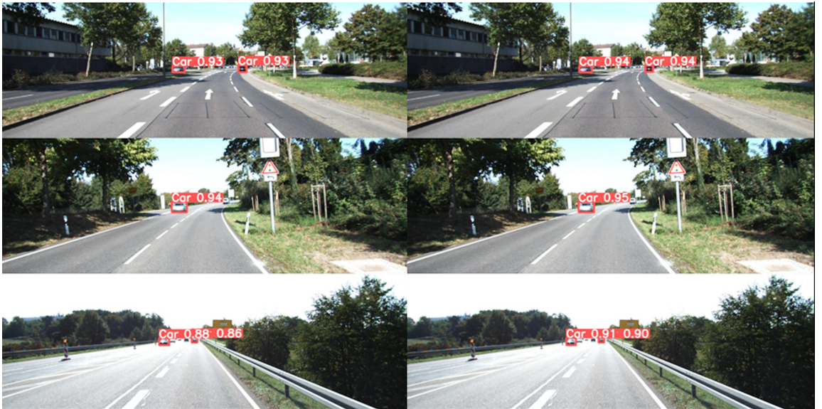
图 9 KITTI 数据集上更换损失函数前后模型的效果对比图
