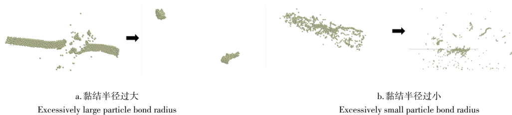
图8 参数不匹配导致的模型破碎
