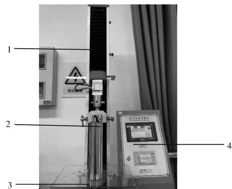
1. 拉力试验机;2. 不锈钢圆筒;3. 玻璃底板;4. 控制机构 1. Tensile testing machine;2. Stainless steel cylinder;3. Glass base plate; 4. Control mechanism
