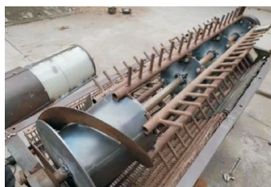
图 11 油莎豆脱粒分离装置内部结构图
