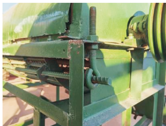
图8 脱粒间隙调节机构
