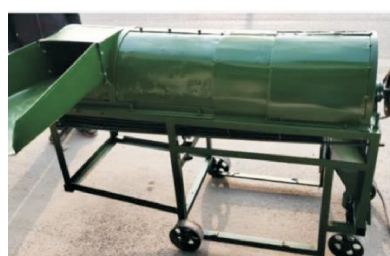
图 12 油莎豆脱粒分离装置整体图
