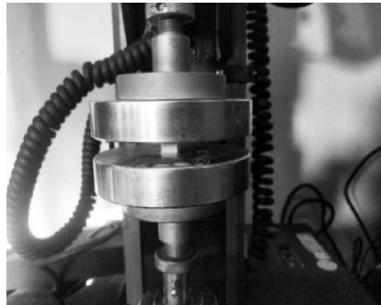
图6 薯块压缩试验
