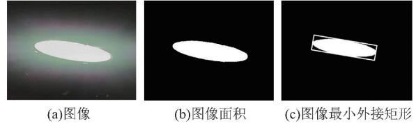
图10 巷道圆形照明灯1及图像面积
