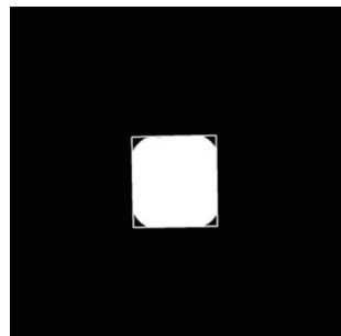
图 6 正方形光源图像最小外接矩形 Fig. 6 Minimum bounding rectangle of square light sources image
