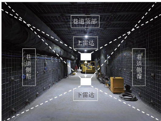
图11 毫米波雷达阵列数据采集方式 Fig. 11 Millimeter-wave radar array data acquisition method
