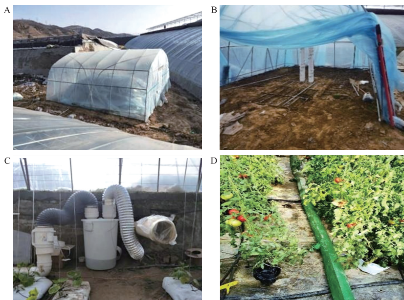
图2 发酵棚体(A)、强制换热装置(B、C)和室内加热管(D)
