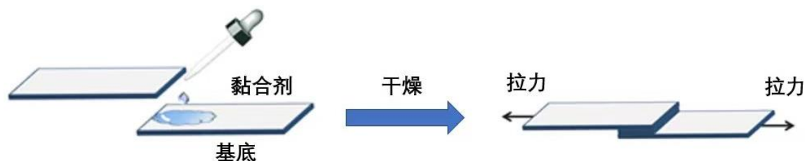
图1 搭接实验样品制备的示意图
