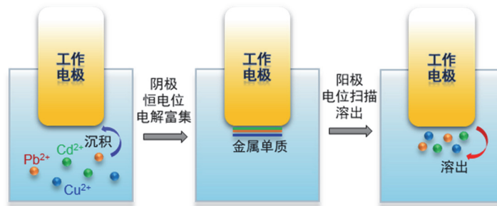
图8 阳极溶出法的富集与溶出过程
