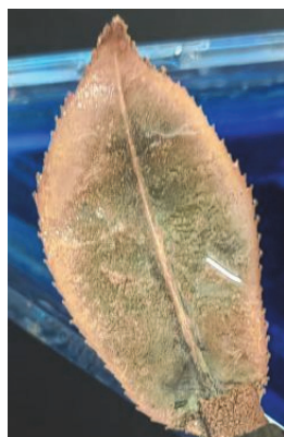
图5 树叶镀铜过程(1.5 A, 电镀4 min 30 s)
