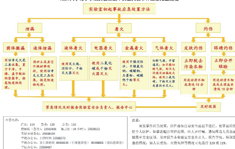
图1 南开大学化学学院实验室技术安全突发事件应急处置流程
