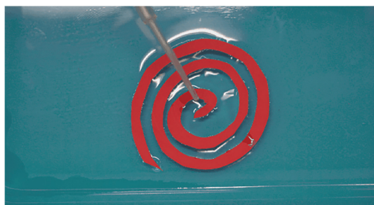
图10 在螺旋形纸片中央的水面滴入AFFF
