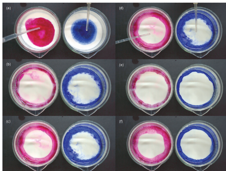
图13 在色素溶液上滴加洗洁精水溶液或AFFF
