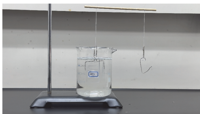
图15 简易拉脱法测定表面张力实验的装置照片
