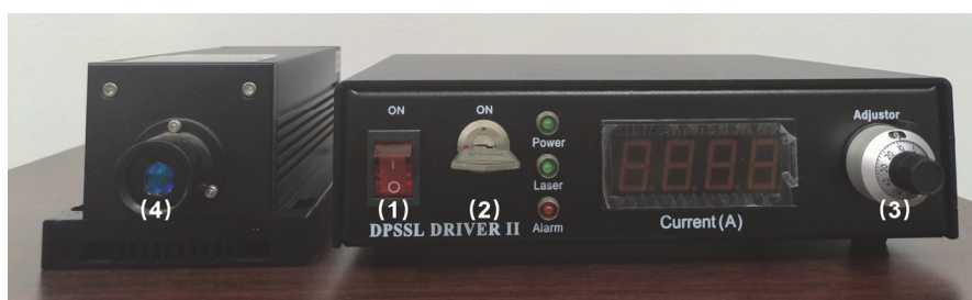
图3 上转换荧光测试系统的激光光源实物照片
