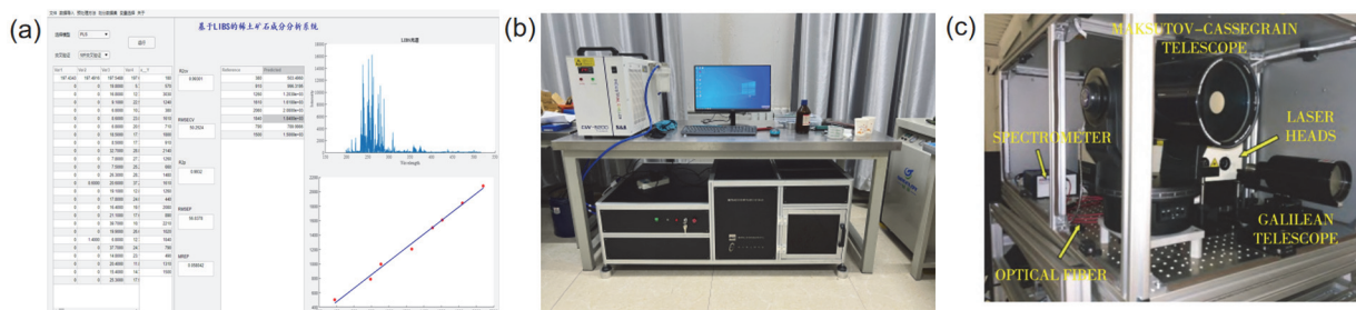
图4 (a) LIBS稀土矿石成分分析系统；(b) 稀土磁性合金材料现场监测； (c) 大气气溶胶中颗粒物成分现场监测 [13]
