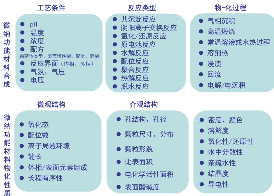
图3 微纳功能材料研发的工艺条件、反应类型、物-化过程及主要调控的微观-介观结构及物理-化学性质归纳
