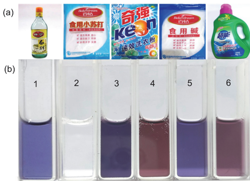
图7 (a) 生活中常见物质；(b) 生活中常见物质加入EGCG与 \text{Fe}^{2+} 配合物溶液后的颜色变化
