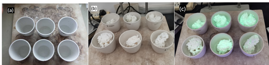
图1 (a) 原料混合物溶液; (b) 自然光下的燃烧产物; (c) 紫外光下的燃烧产物
