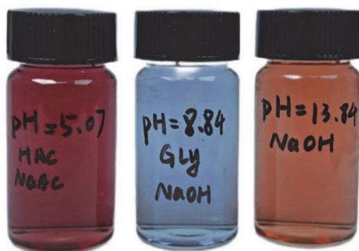
图2 不同pH条件下铬黑T溶液的颜色
