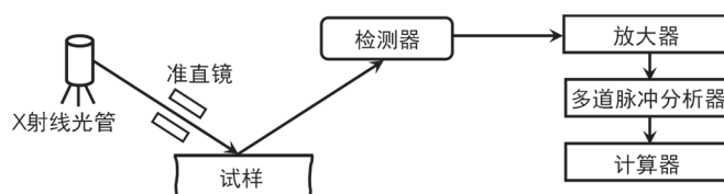
图4 ED-XRF光谱仪的工作结构示意图
