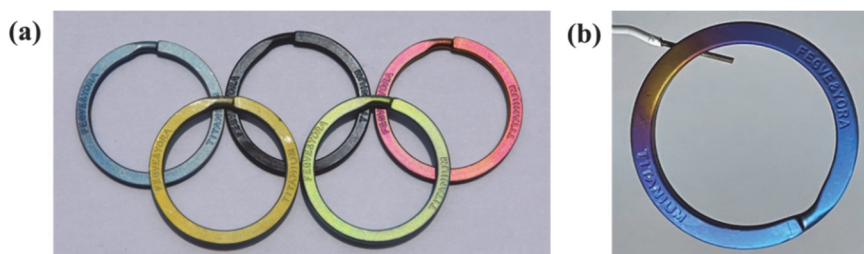
图10 (a) 不同阳极氧化颜色的钛圈组成的五环图案；(b) 钛圈细节展示
