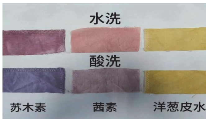
图7 加入铝媒染剂后经水洗和醋酸洗后效果
