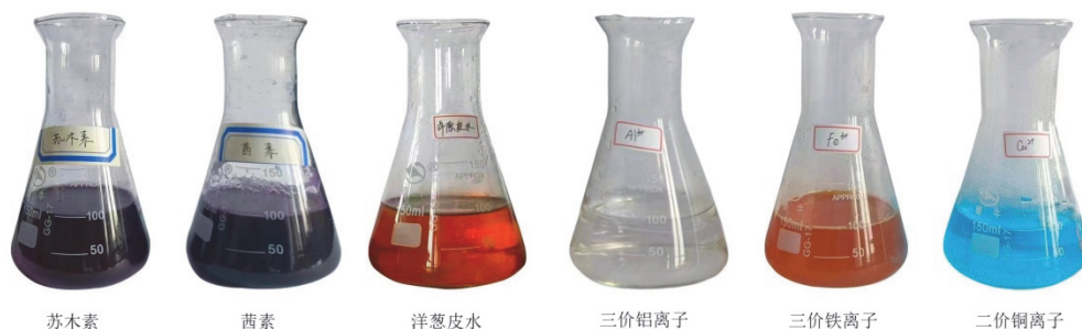
图4 制得茜素、苏木素、洋葱皮染料溶液及媒染溶液
