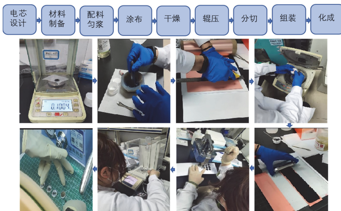
图4 扣式锂电池制作实验流程图及学生的部分操作图
