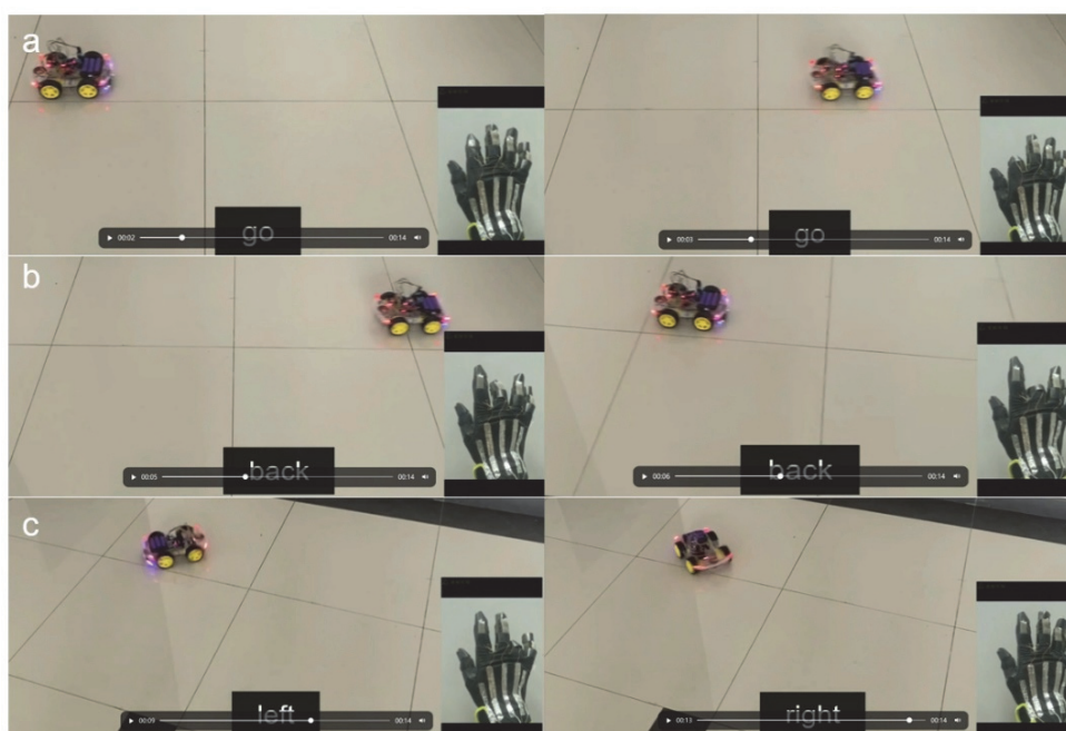
图8 导电水凝胶控制系统控制小车(a) 前进；(b) 后退；(c) 左右转向
