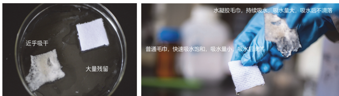
图2 水凝胶与市售毛巾吸水能力的对比
